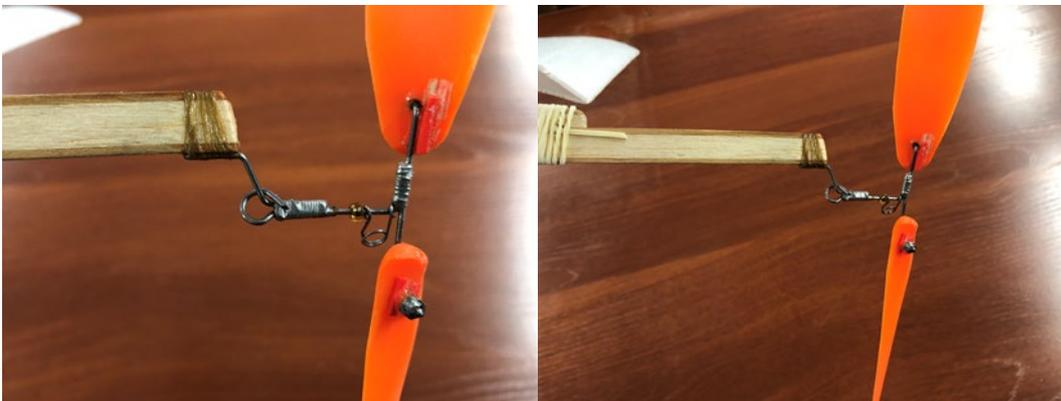
На готовый фюзеляж устанавливаем резиномотор и находим центр тяжести. Крыло закрепляем относительно центра тяжести 55% от передней кромки крыла. Приматываем резиновую нить. Наша модель свободнолетающая, поэтому за качество полета модели отвечает правильная геометрия модели и равномерное распределение веса относительно центра тяжести модели.
